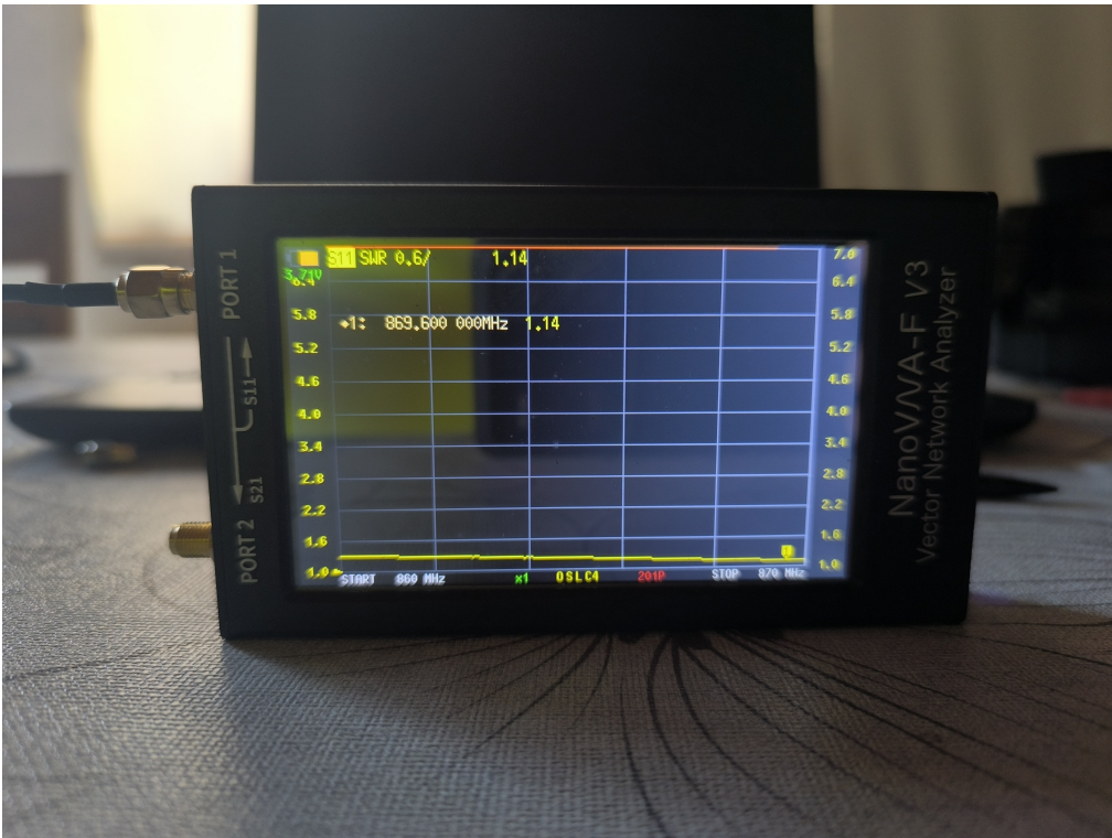
Der Abgleich der Co – Co Antenne mit dem NanoVNA – F V3 bei einem SWR von 1:1,4.
