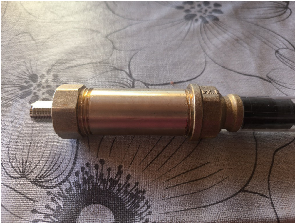
Antennen Befestigung mit N Einbau Buchse in einem 1 Zoll Messing Rohr.
